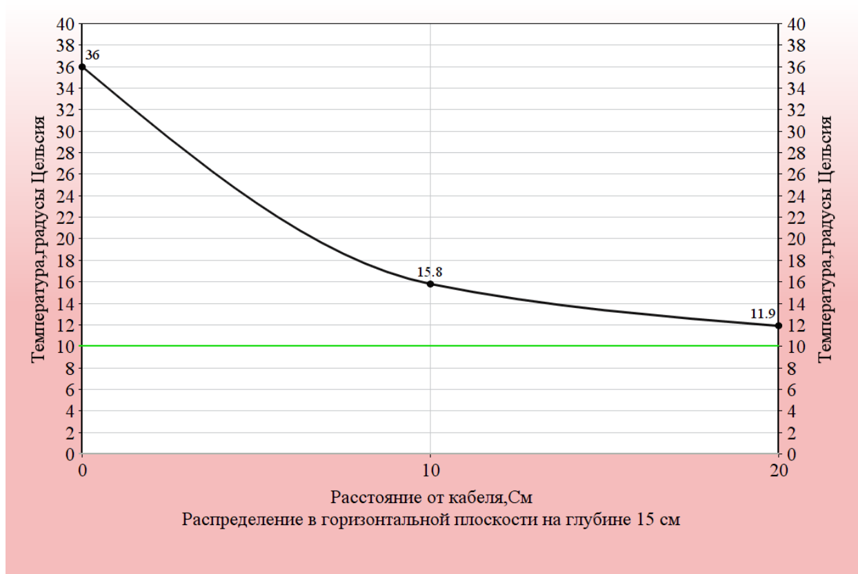
Рис.14 Температура почвы в зоне греющего кабеля
